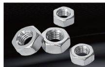
六角螺母 HEX NUT 材质 Material: SUS304 A2,SUS316 A4 规格 Size: M2-M45 1/4" -1-1/2" 标准 Standard: DIN,ASME,ANSI,JIS,GB
