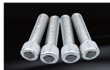
内六角圆柱头螺丝 SOCKET SCREW 材质 Material: SUS304 A2,SUS316 A4 规格 Size: M3-M24 3/16" -1" 长度 Length: 8mm-150mm 标准 Standard: DIN,ASME,ANSI
