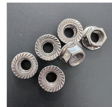
名称：DIN6923法兰螺母 规格：M6-M12 材质：201、304、316
