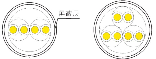
2对电缆的结构示意图
