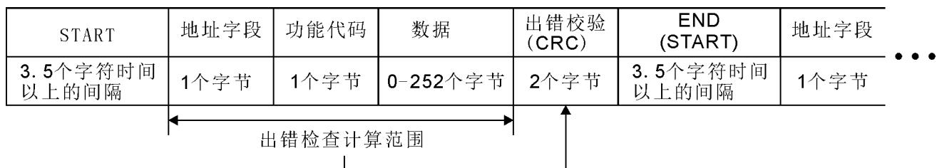
RTU 模式的出错检查通过 CRC (Cyclical Redundancy Checking) 进行。
