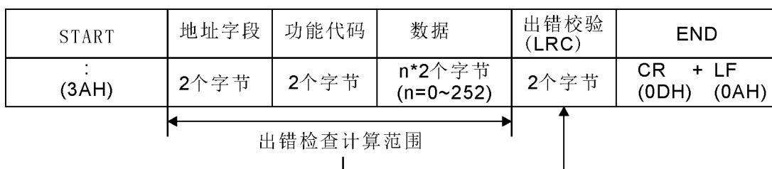
ASCII 模式的出错检查通过 LRC (Longitudinal Redundancy Checking) 进行。
