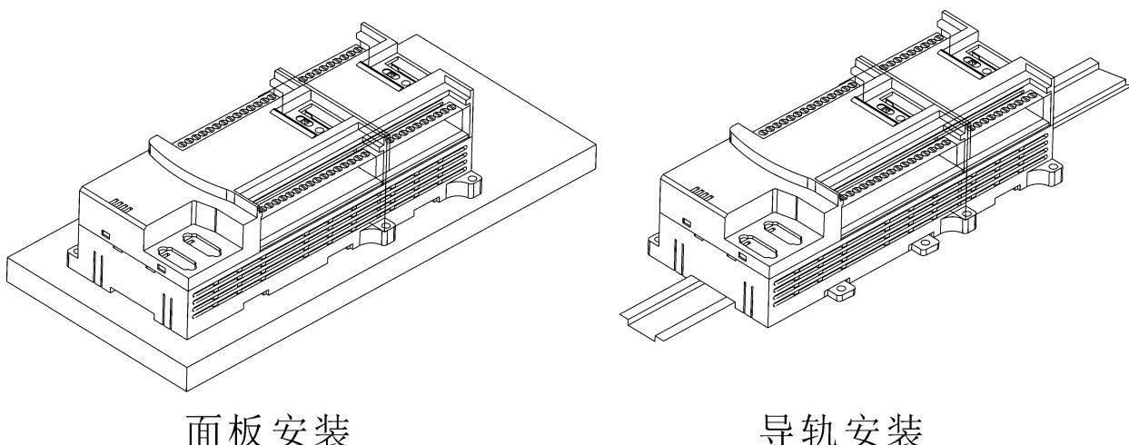
图 3.4.4 LS2 系列 PLC 的安装方式
