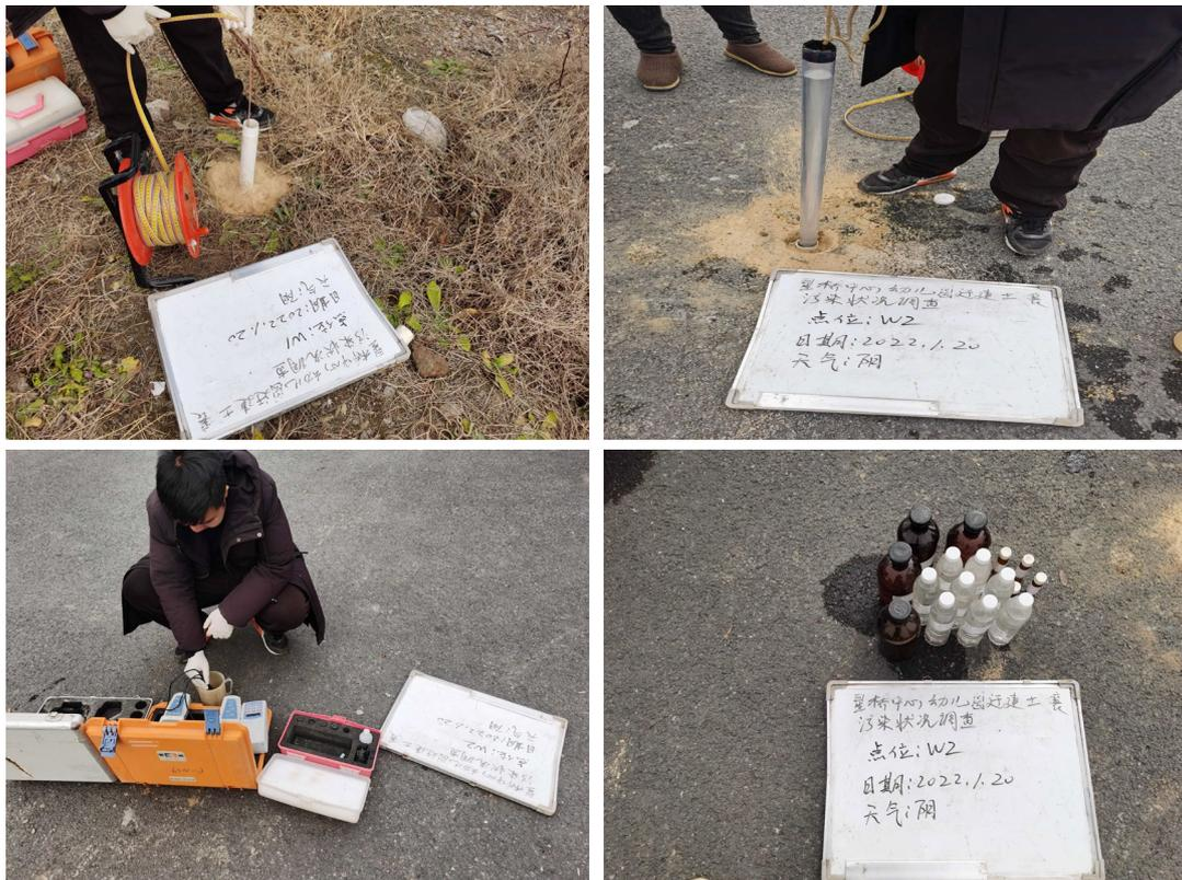
图 5-9 部分地下水采集照片
