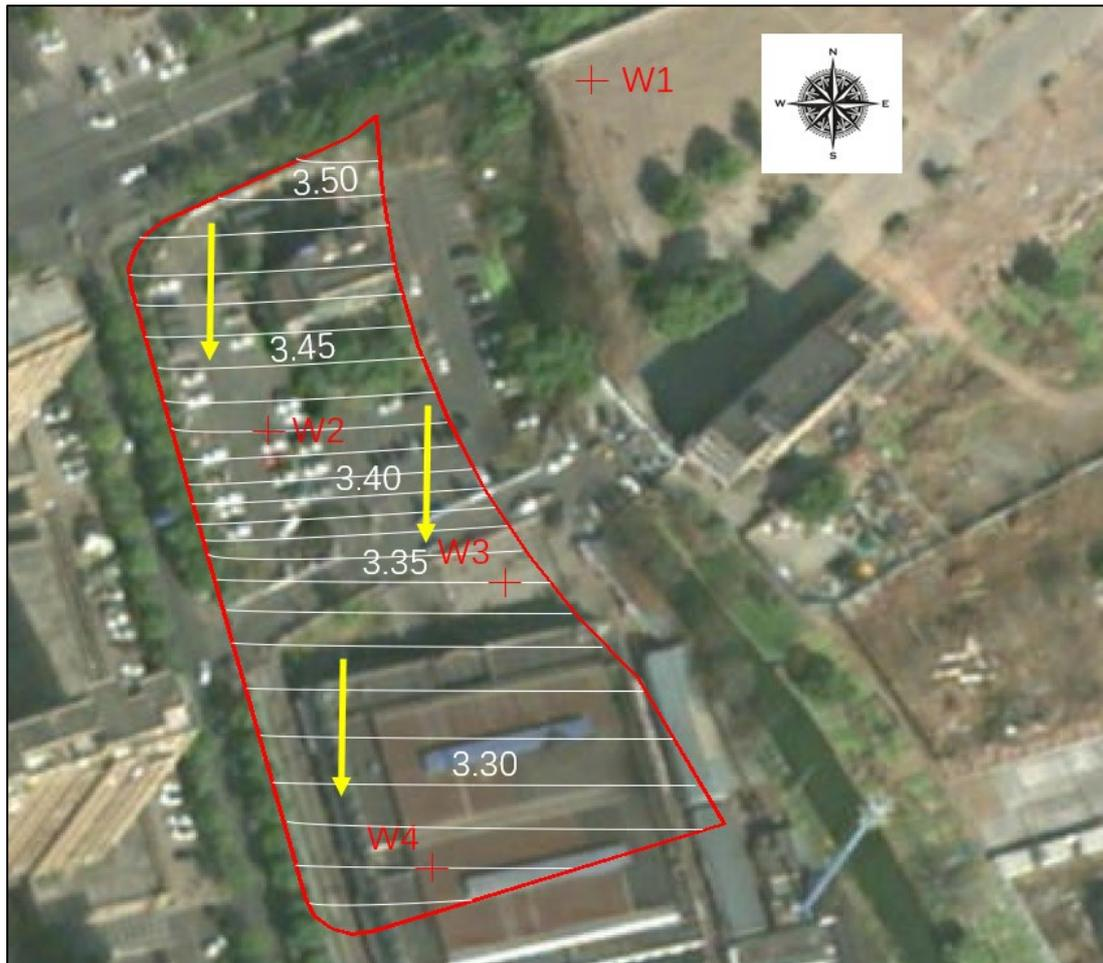
图 5-11 调查地块周边地下水流向模拟图（地下水位高程：米）
