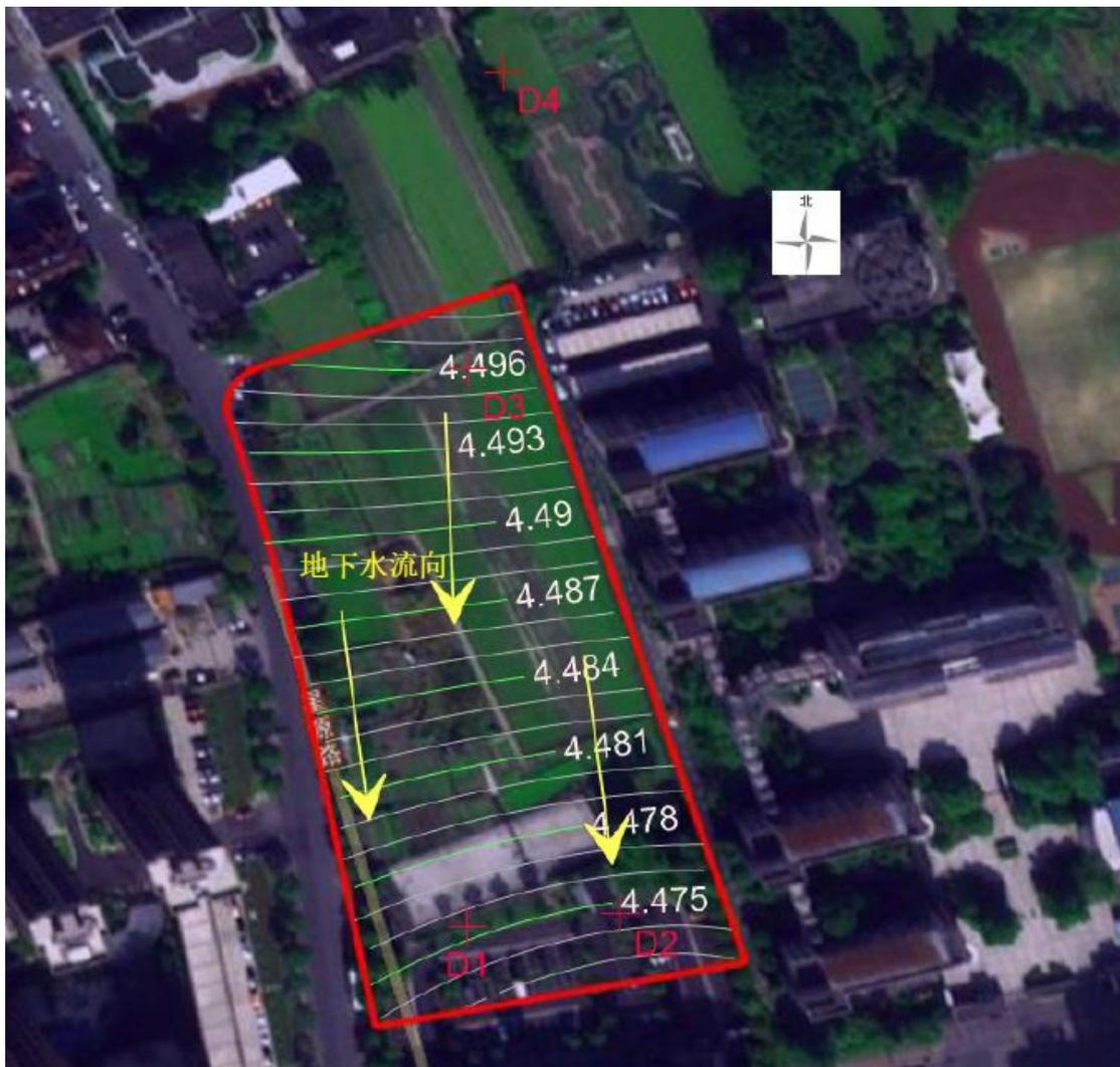
图 3-9 星桥社区城中村改造安置房三期项目地下水流向（高程单位：米）
