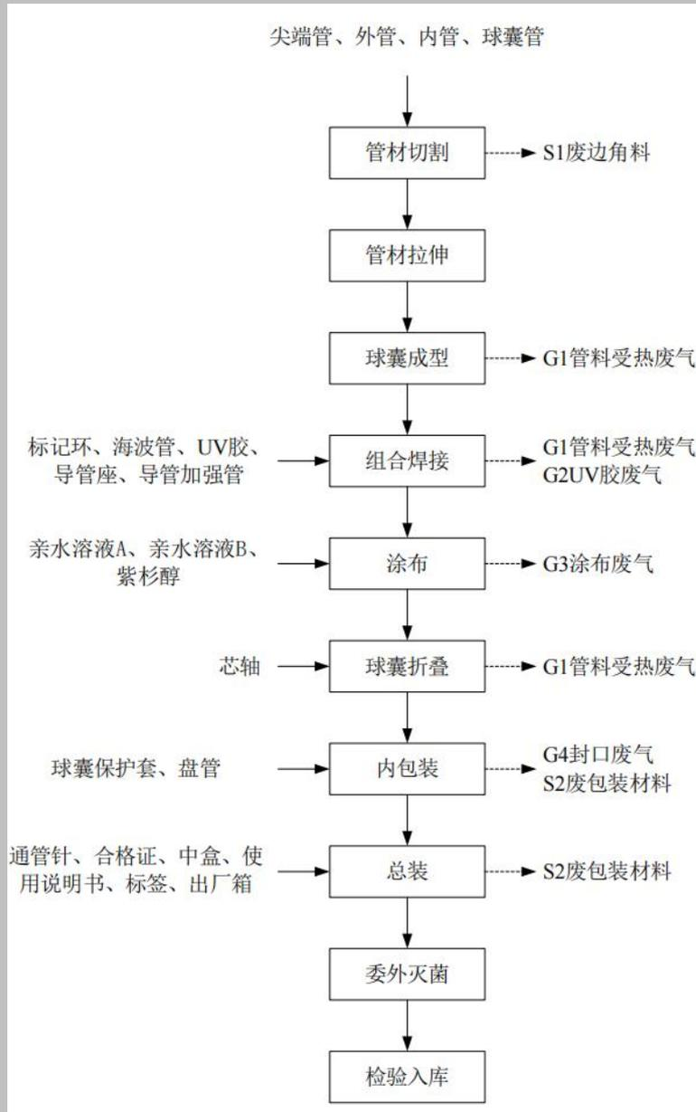
图 2-2 球囊导管生产工艺流程图
