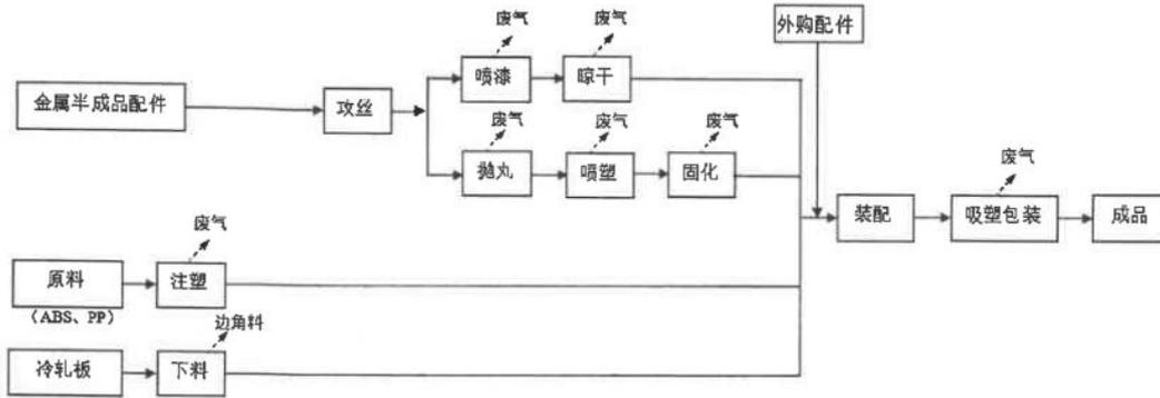
图 2-1 本项目工艺流程及产污环节
