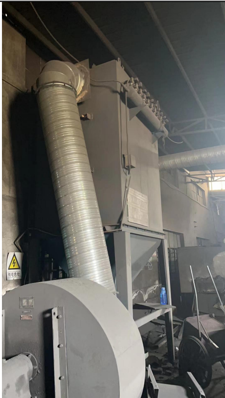
切割、打磨、落砂粉尘（布袋除尘）
