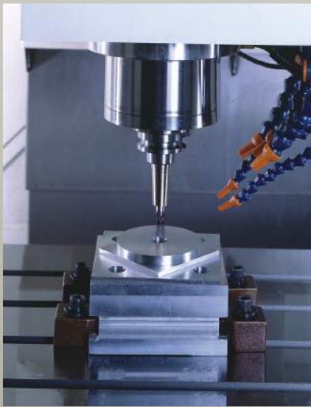
■ 切削完成的標準試塊，需經三次元量床檢測，確保精度符合標準。
