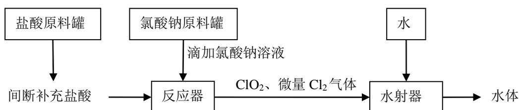
图 4.6-1 二氧化氯发生器反应流程图
