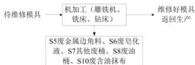
图 3.3-4 本项目模具维修生产工艺流程及产污环节图
