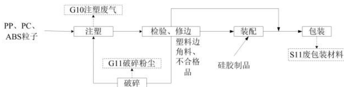
图 3.3-3 本项目塑料制品生产工艺流程及产污环节图
