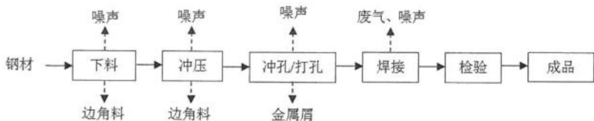
图 3.3-1 本项目跑步机和按摩椅主架生产工艺流程图
