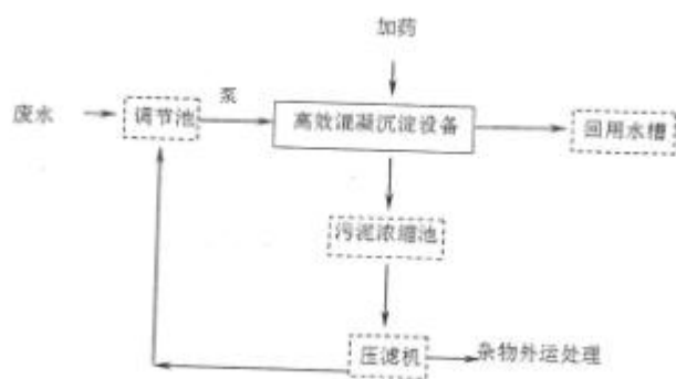
水帘池和喷淋塔更换废水处理流程
