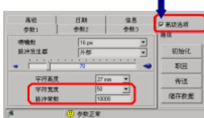
为了保证喷印图案的清晰（既不拥挤又不模糊），你需要根据喷码机的行进速度调整喷印列数的频率。该调整通过以下喷印参数进行设置：
