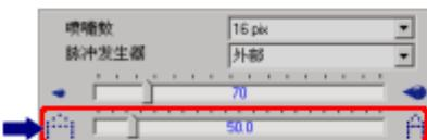
本参数定义喷印文本的分辨率（每寸内的点数）。参数**字符宽度**改变后，文本外观效果将表现为字符宽度改变及整个文本的长度改变。
