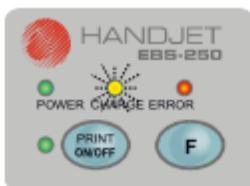
当喷码机电池低电量时，蜂鸣器**35**产生蜂鸣信号，同时充电指示灯**22**闪烁：
